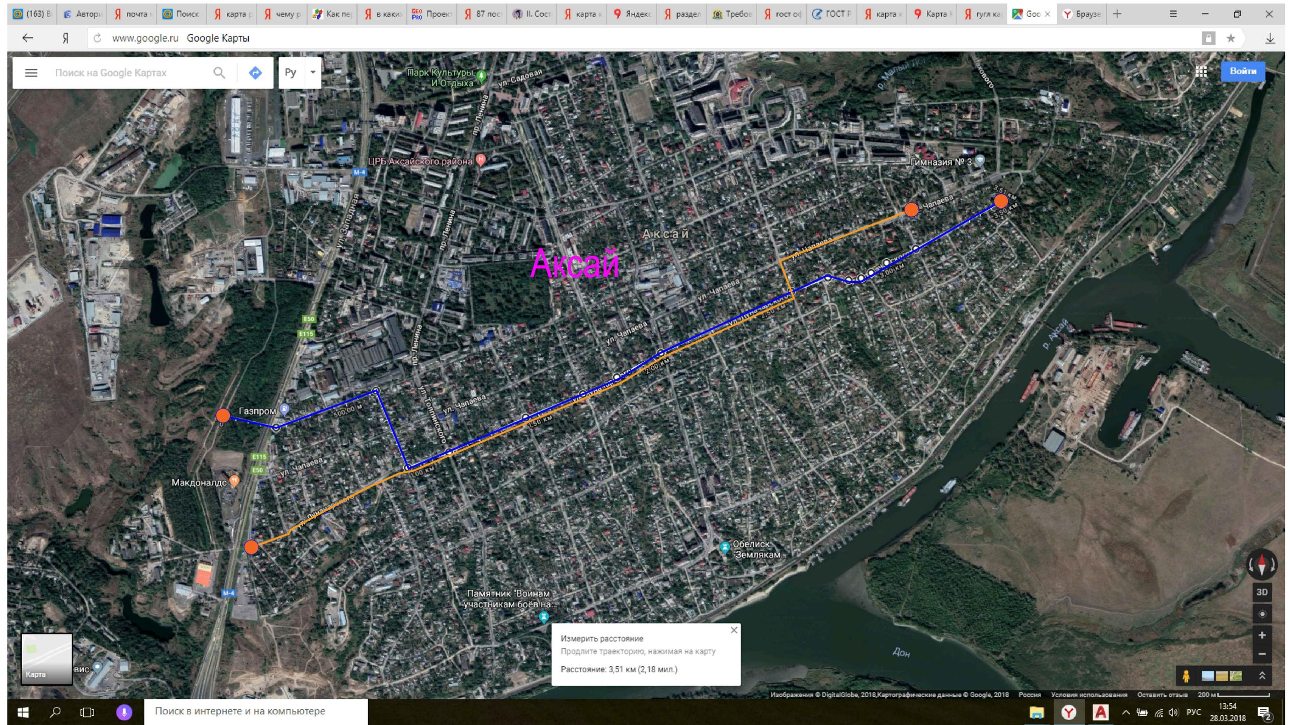
общая протяженность водовода 3,5 км (уточняется при проектировании), канализационной сети 3,3(уточняется при проектировании).
