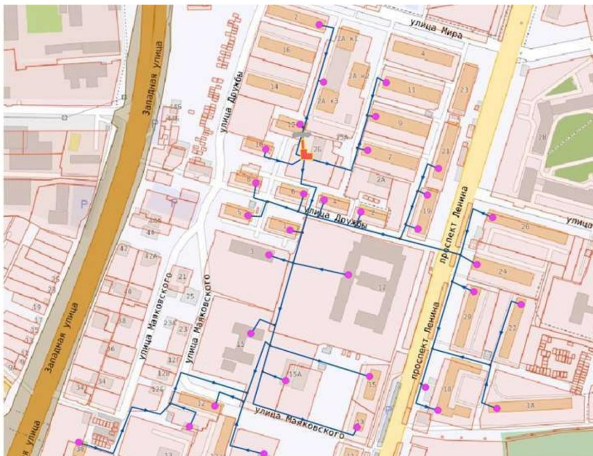
Рисунок 20 Схема теплоснабжения котельной № 3
