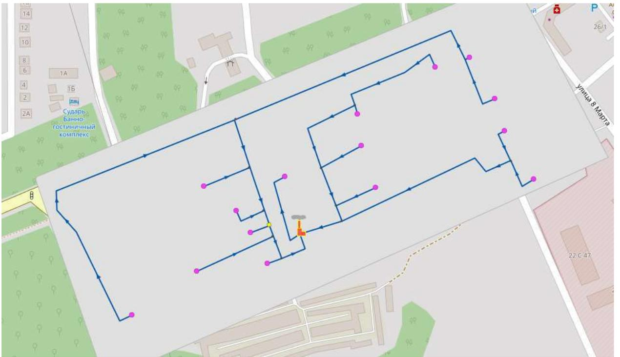
Рисунок 25 Схема теплоснабжения котельной МУП АГП «АКСАЙЭНЕРГО»
