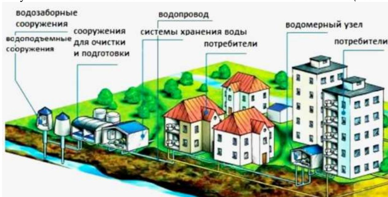
Рисунок 3 Технологическая схема источников ЦСТХВ
