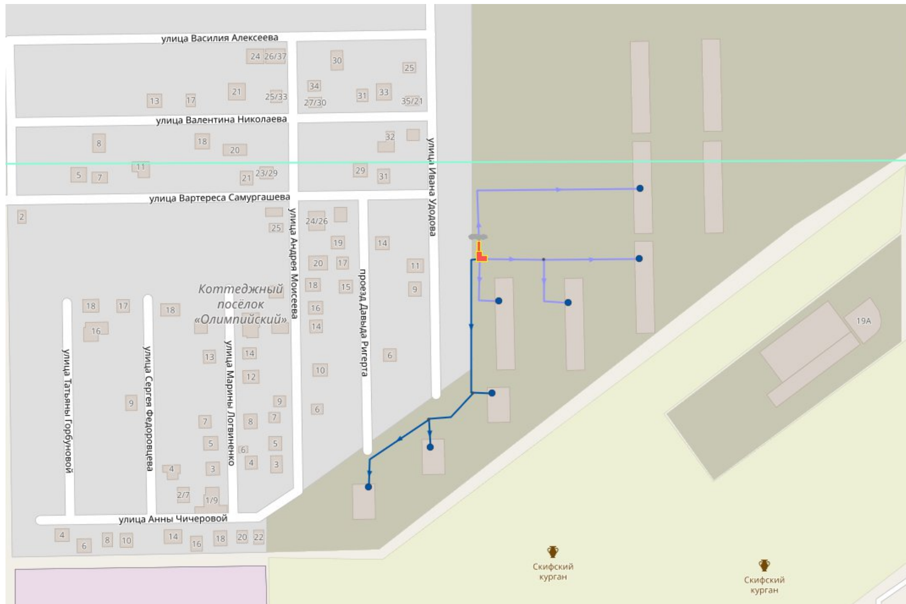
Рисунок 15 Карта (схема) тепловых сетей в зоне действия котельной ООО «РГБ»
