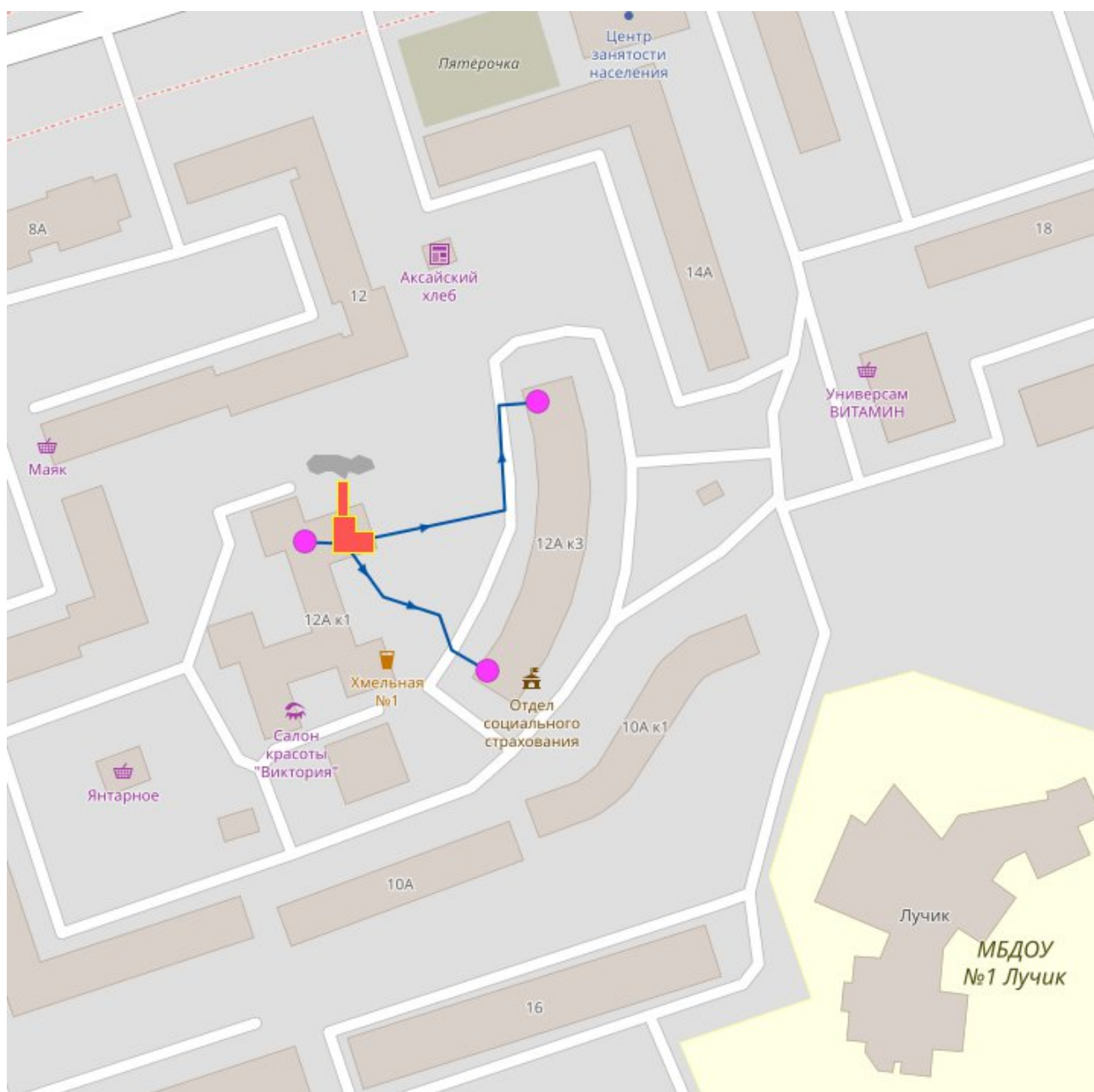
Рисунок 14 Карта (схема) тепловых сетей в зоне действия котельной МУП АГП «Аксайэнерго»
