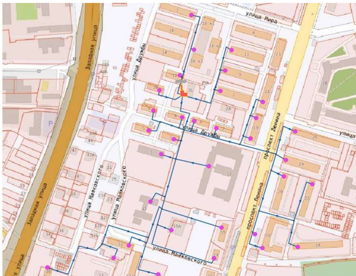
Рисунок 20 Схема теплоснабжения котельной № 3
