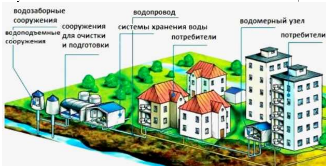
Рисунок 2 Технологическая схема источников ЦСХПВ
